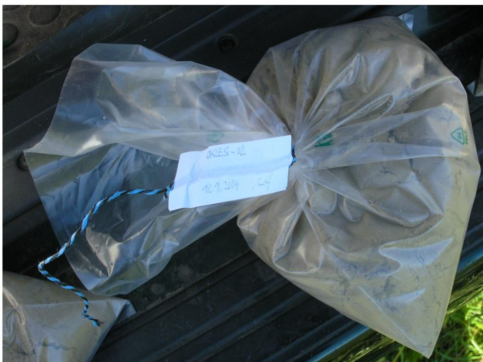
Abb. 2.1: Versiegelte Dolomitkalkprobe für Zweitanalysen der Korngrößenzusammensetzung sowie des Wirkstoff- und Schwermetallgehalts (Foto: R. Novotný)
