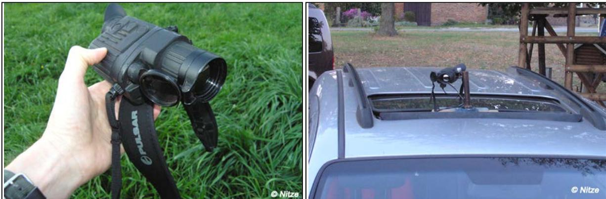
**Abb. 13** Die Wärmebildkamera (hier Pulsar Quantum HD38S mit 38mm-Objektiv) wird bei der Suche handgeführt oder beweglich auf dem Fahrzeug montiert.
