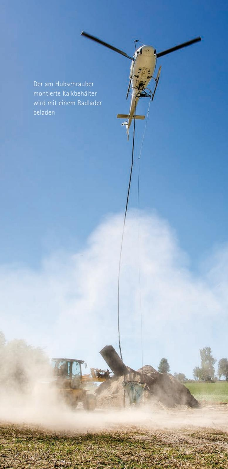
Der am Hubschrauber montierte Kalkbehälter wird mit einem Radlader beladen
